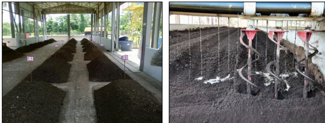
Figura 29 - Compostagem aeróbia de resíduos orgânicos em leiras. Compostagem mecânica de dejetos suínos.
