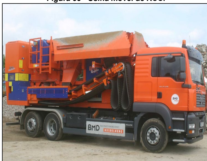
Figura 35 - Usina móvel de RCC.
