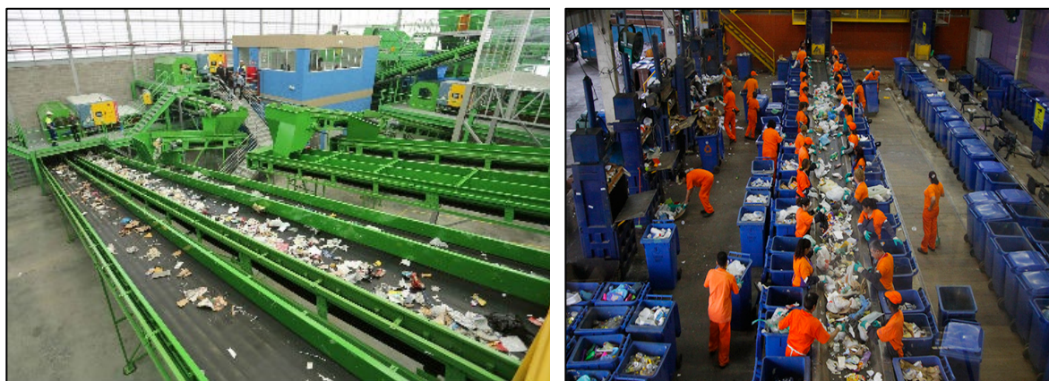
Figura 27 - Centro de Triagem de Resíduos Sólidos - CTRS e segregação de resíduos recicláveis e não recicláveis.
