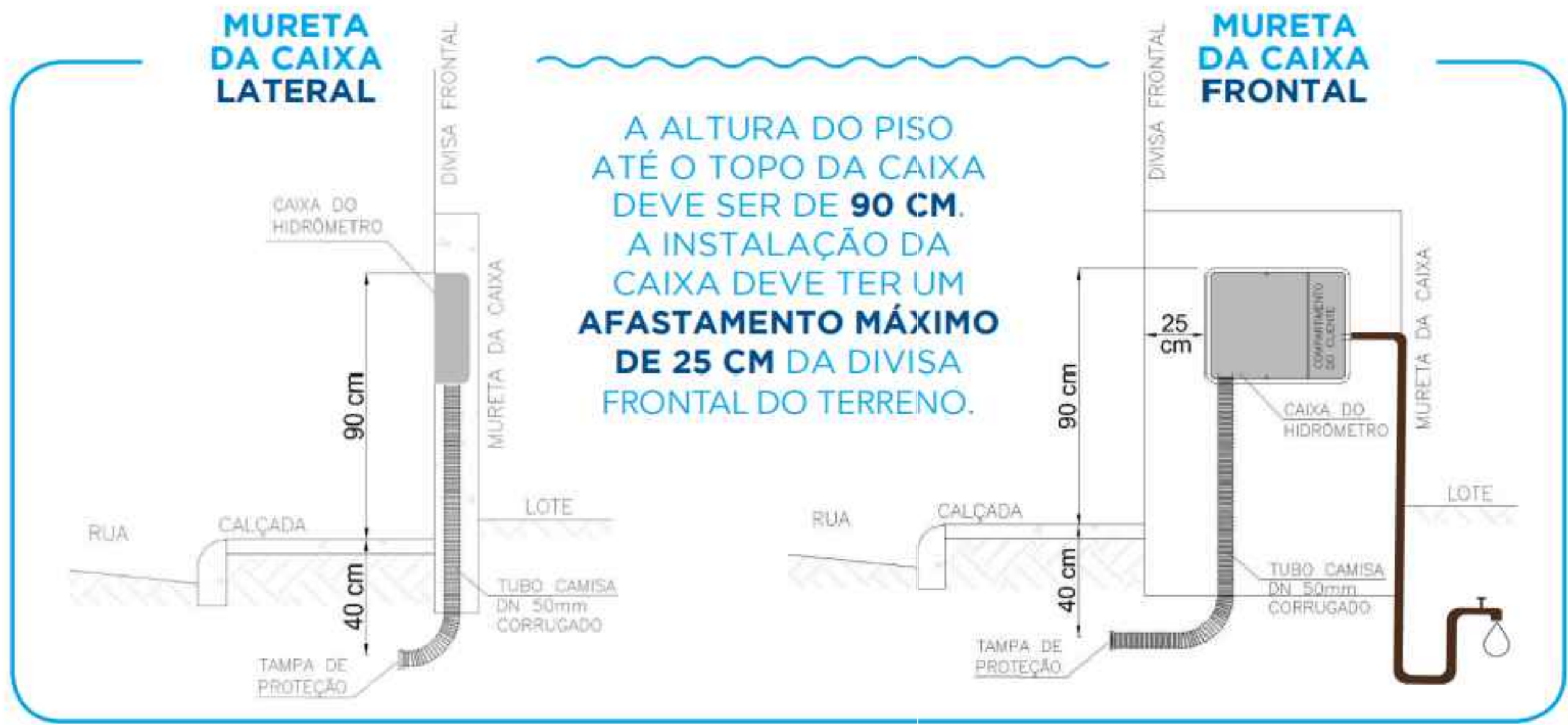
DETALHE PADRÃO CORSAN ENTRADA DE ÁGUA
